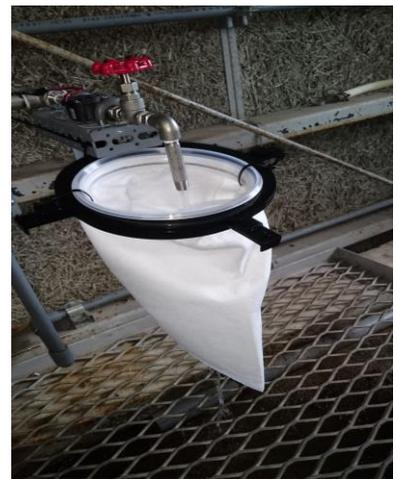
事業場総合排水排水管からサンプル水を吸い上げ、プラスチック類の混入量を定期的に調査を実施しております。
