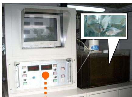
排水の監視 (魚の動きによる有害物質の検知)
