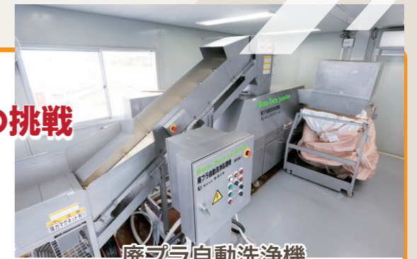
廃プラ自動洗浄機 『300kg/hの処理能力、1日1トン強の量を洗浄』
