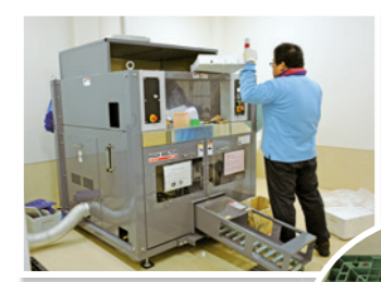
発泡スチロールも大切な資源です。減容レインゴッドに加工することで、効率的に輸送でき資源価値が上がります。
