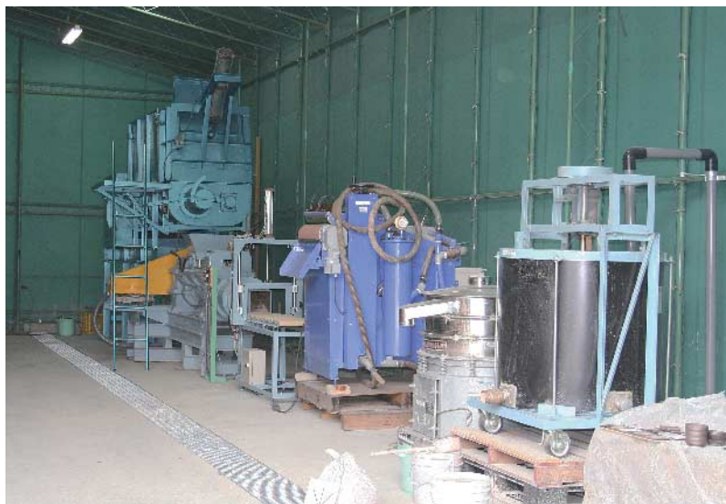
エコ土の製造 釉薬廃泥を陶土に混ぜ、「エコ土」として再利用する設備
